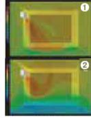
左の熱カメラ写真は、断熱・気密性能の高い①の住宅と②の断熱性能が低い住宅のエアコンの空気の流れを比較した熱カメラの写真です。①の場合は、エアコンの熱がしっかりと床まで届いていますが、②の場合は、床まで届かず部屋の中で急上昇します。①の場合は、部屋全体が暖かくなっていきますが、②の場合は、床が外気の寒さに影響されて、時間が経っても寒さは収まりません。これが断熱・気密性能の差です。エアコン1台で冷暖房が可能な住宅と、エネルギー消費の大きい住宅の差は、こうして生まれます。
